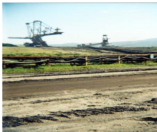
Fig.3.Transportoare cu bandă de mare capacitate cu lățimea covorului între 1400 ÷ 2250mm și mașini de haldat tip A 2 R 5 B
